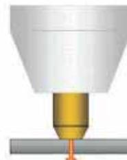
Para lograr los mejores resultados, utilice la copa de protección con la punta de la antorcha en contacto directo con la pieza (hasta 60 A).
