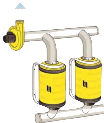
Ejemplos de montaje de Filtro para instalaciones fijas
