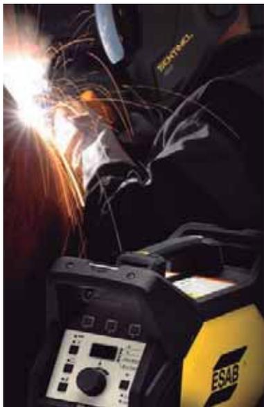
Compatible con Generadores, para un uso flexible en diferente tipos de trabajos en exteriores. Control de Arco / Arranque en Caliente Automático que permite soportar las diferentes demandas del trabajo. Amplio rango de tensión de entrada para soportar los requerimientos de cualquier zona en el mundo. Versatil y flexible bajo las condiciones mas duras de la industria y la construcción metálica. el diseño esta pensado para facilitar el uso y movilidad insitu.
